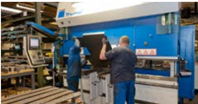
Computerunterstütztes Biegen von Stahlplatten
