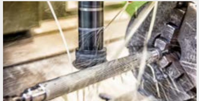
Fräsen der Antriebswalze
