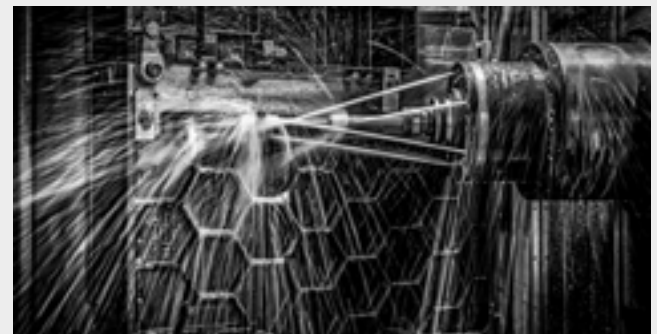
CNC-Bearbeitung von Gusseisentischen
