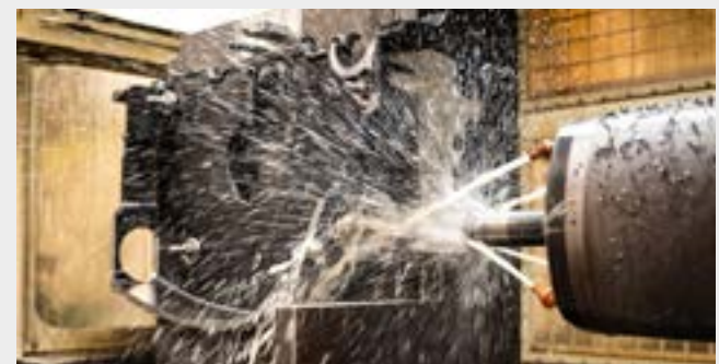
CNC Bearbeitung von gusseisernen Sägeaggregaten
