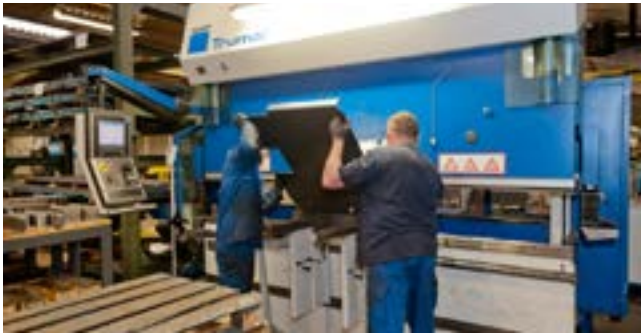
Computerunterstütztes Biegen von Stahlplatten
