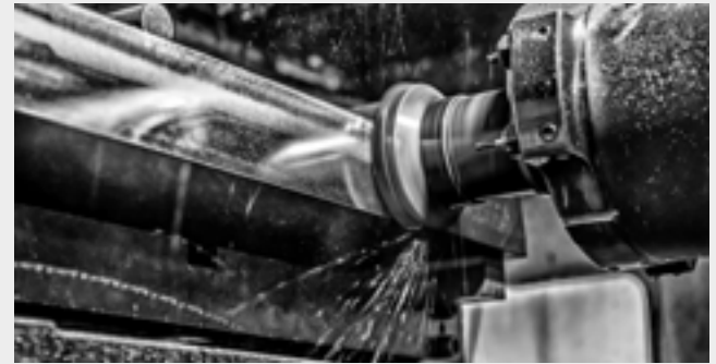
Kantenfräsen von Gusseisentischen
