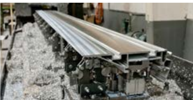
Fräsen der Schiebetischfläche
