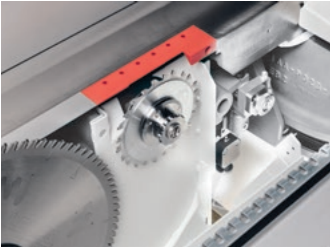
2-Achsen-Vorritzer T77, mechanisch einstellbar | T7751
