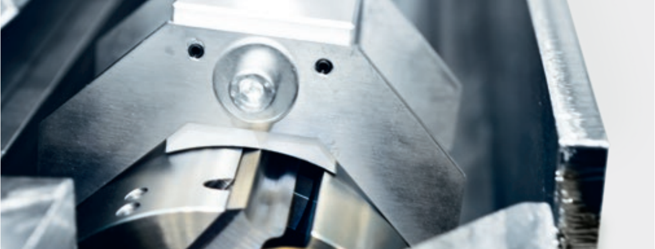
Keilleistenmesserwelle mit Einstellgerät | T543
